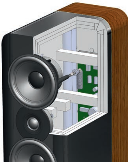
Przekrój górnej części obudowy z widocznym mocowaniem głośników nisko-średniotonowych, listwami P2P, rurami HPE (z tyłu, na bocznych ściankach) i skorupą Dual Gelcore.
